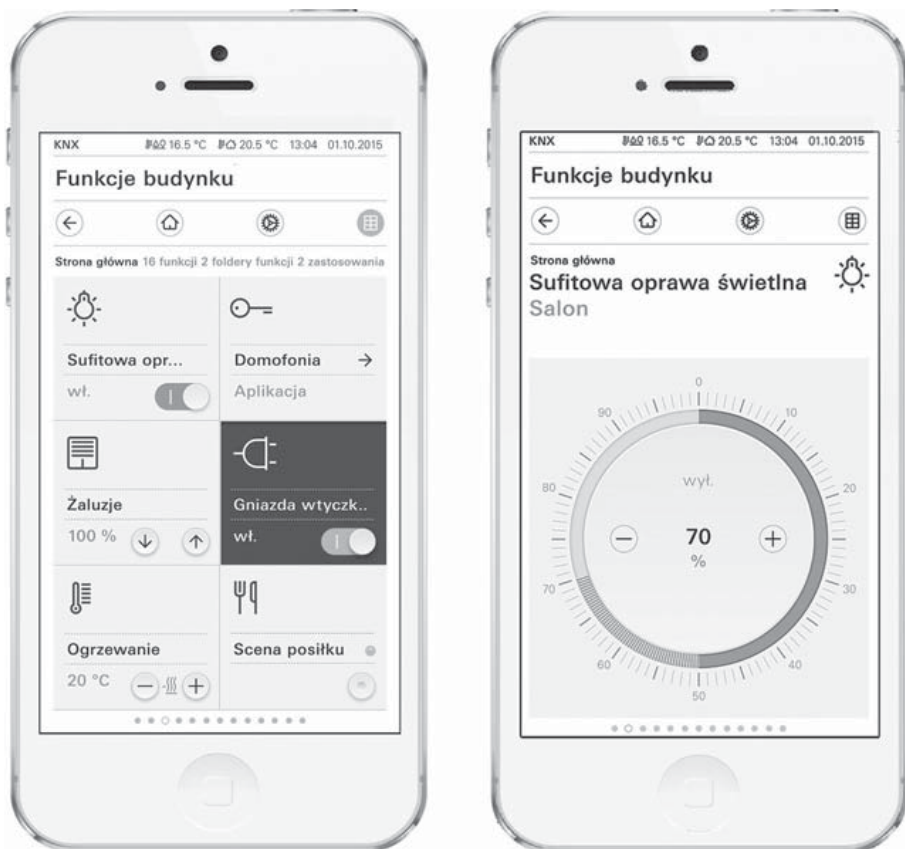
Rysunek 7-2. Przykład menu kafelkowego na wyświetlaczu urządzenia mobilnego. (Kafelkami nazywane są kwadratowe aktywne pola, których działanie jest opisane słownie oraz za pomocą piktogramów. Napisy mogą być tworzone po polsku.)
