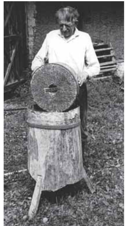
Żarna kadłubowe z kołami żarnowymi wykonanymi z drewna z nabitymi kawałkami żeliwa. Suwalszczyzna, wieś Posejny koło Sejna, 1970
