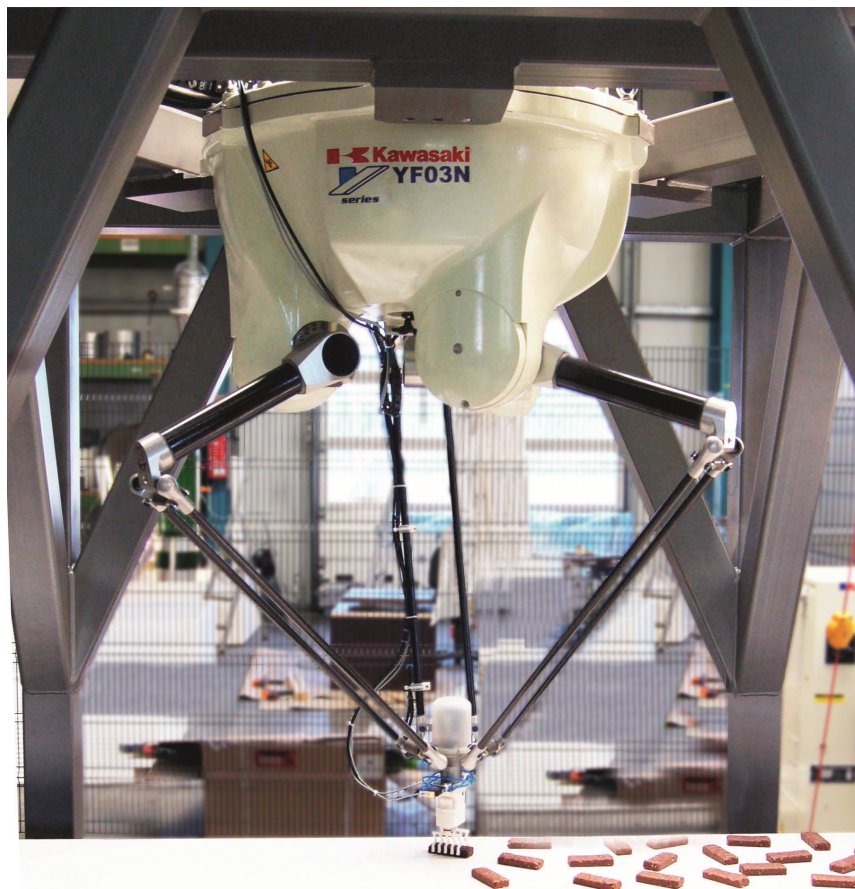
■ Rys. 5. Robotyzacja procesu pakowania czekoladek.
